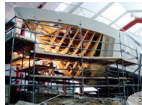
1-5 | Mathis Værft måtte bygge en ny model til stævnen, for tegningerne kom først, da støbearbejdet var slut. Foto udlånt af Mathis Værft.
